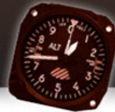
El altímetro es un instrumento de precisión que permite determinar la altitud de un lugar.
