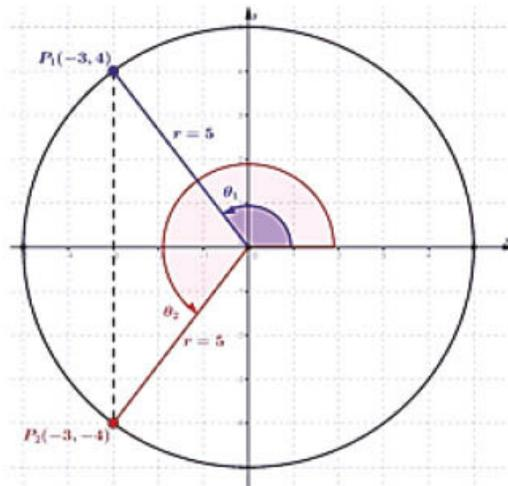
11. Si el centro del radar representa una posición definida, se pueden determinar los radios de las circunferencias que pasan por los puntos que representan los objetos y sus coordenadas de modo que con esa información, sea posible determinar los ángulos que ayuden a determinar las posiciones de los objetos con respecto al centro del radar. Para ello si son importantes las definiciones trigonométricas estudiadas.
