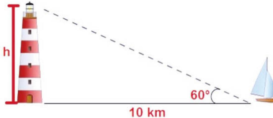
**Consideraciones necesarias para resolver el problema:** que la línea para medir la separación entre la base del faro y la embarcación sea horizontal. Esto implica que el faro no se encuentre sobre un monte o que el suelo tenga alguna inclinación.
