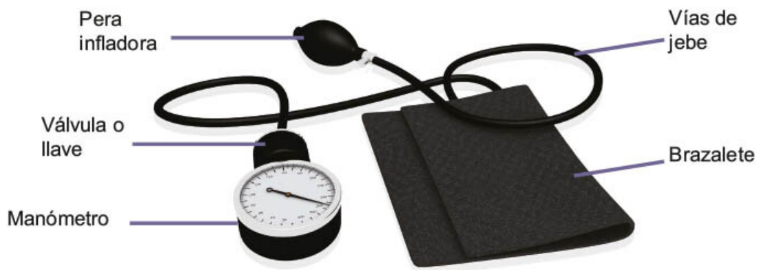
Figura 1.13. Partes de un esfigmomanómetro.
