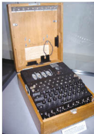
Figura 3.11 Enigma, máquina de cifrado alemán. Permitió enviar mensajes durante la Segunda Guerra Mundial.
