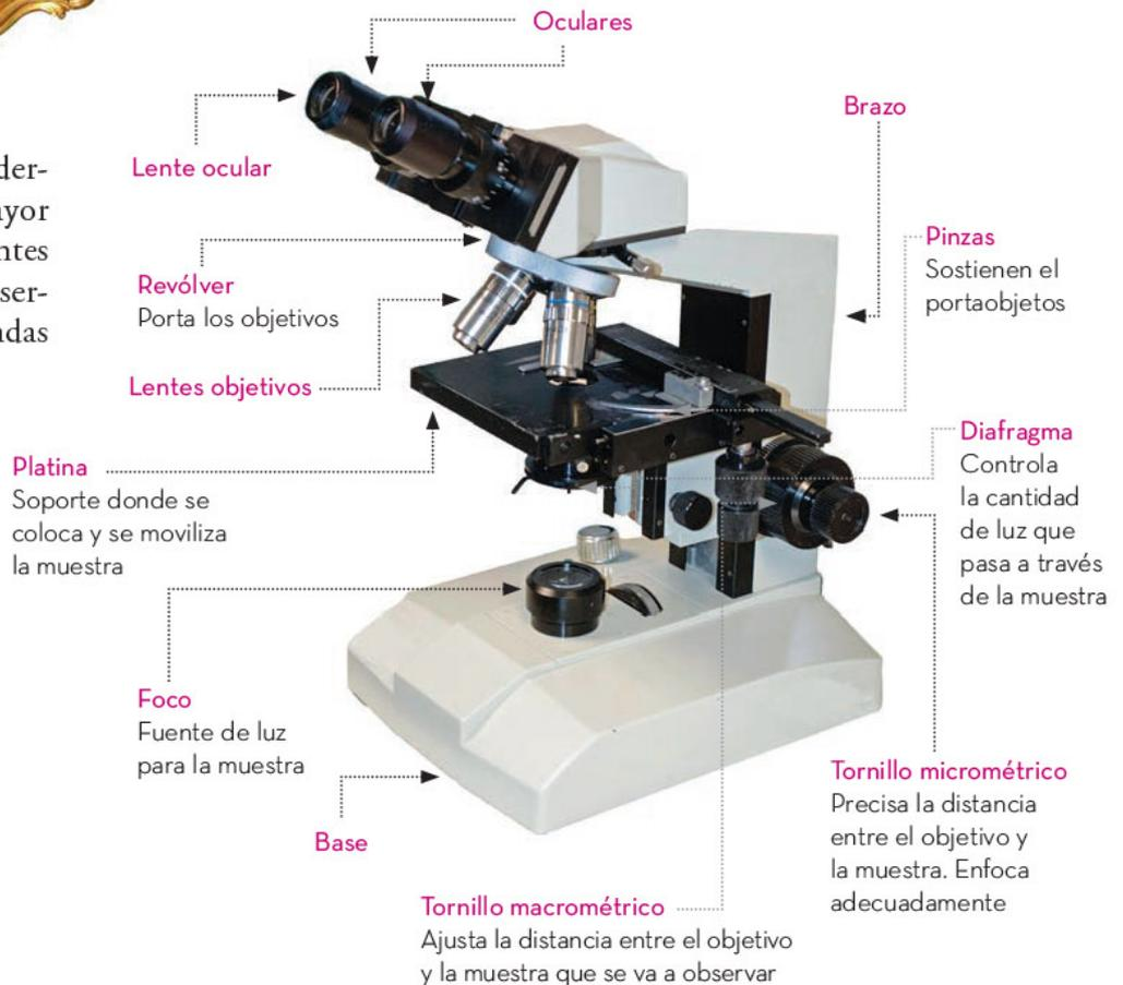
Se han diseñado varios tipos de microscopios que permiten observar objetos muy pequeños. Ahora, con los microscopios electrónicos que, en lugar de luz, utilizan otros recursos para amplificar las imágenes de los objetos observados, se ha logrado aumentar hasta 300 mil veces la imagen del objeto observado; y los hay mucho más complejos pues los microscopios electrónicos de transmisión, por ejemplo, logran magnificaciones de hasta 10 millones de aumentos.
