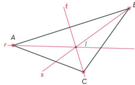
3. Con apoyo de una escuadra, trazar una recta perpendicular a uno de sus lados que pase por el incentro  $I$ , como se muestra en la imagen, y ubicar el punto  $D$  en la intersección del lado y la perpendicular.
