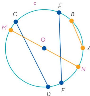
Una cuerda es el segmento delimitado por dos puntos de la circunferencia, en el ejemplo de la izquierda se muestran las cuerdas  $AB$ ,  $CD$  y  $EF$ . Para trazar una cuerda se deben ubicar dos puntos en la circunferencia y unirlos.
