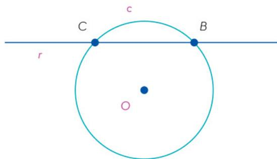
Una recta secante  $r$  de una circunferencia  $c$  es aquella que la interseca en dos puntos de ella. Para trazar una recta secante a una circunferencia se deben conocer dos puntos  $B$  y  $C$ , y trazar una recta que pase por ambos puntos.
