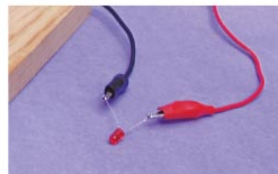
Figura 4.25 Cada extremo del led corresponde a un polo: (+) o (-).
