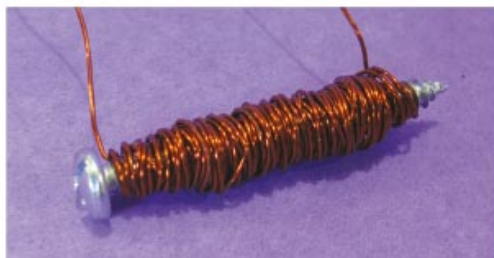
Figura 4.17 El alambre enrollado no debe tener espacio entre las vueltas del mismo.
