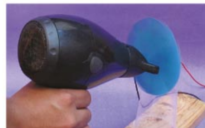
Figura 4.27 La secadora proporcionará el viento para mover las aspas.
