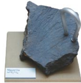
Figura 2.16 La magnetita es un mineral con la propiedad de atraer material ferroso, es decir, con hierro.
