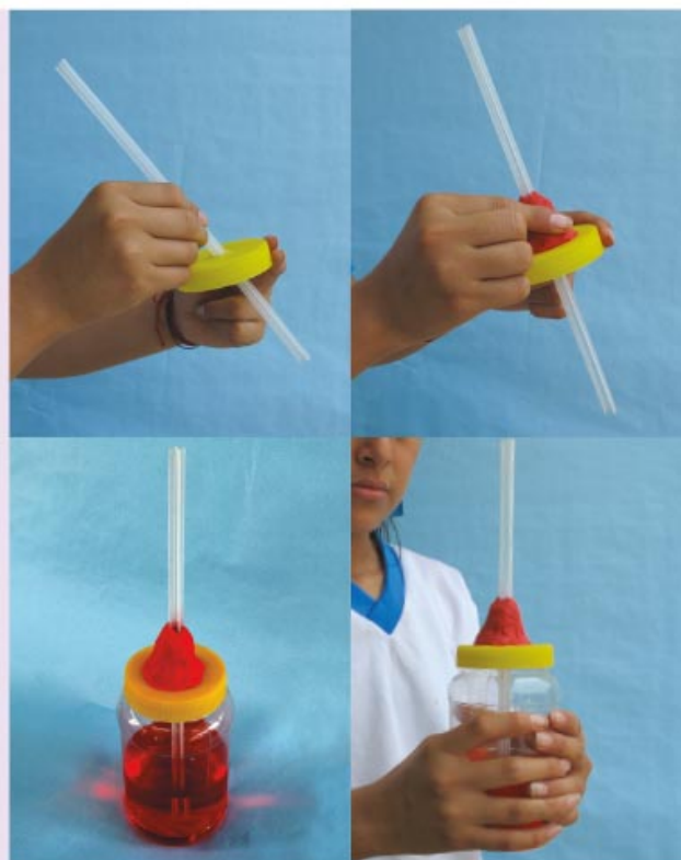
Modelo de termómetro con frasco, agua y popote.
