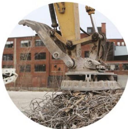
Figura 2.28 Al activar el electroimán se levanta el cascajo metálico; al desactivarlo, se suelta el material sin necesidad de abrir o cerrar mecanismos.
