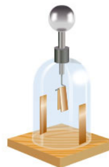
Figura 2.8 El electroscopio está formado por una esfera metálica unida a un alambre, y éste a su vez a dos laminillas metálicas.
