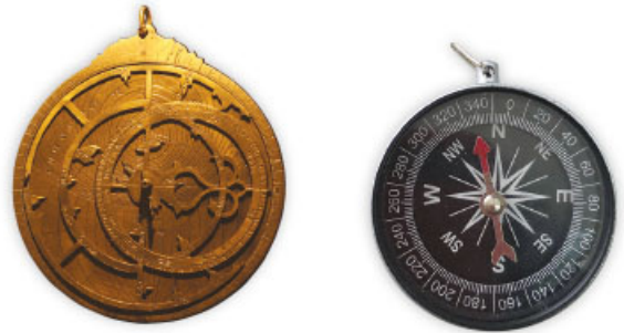
Figura 2.15 Los navegantes antiguos se orientaban en mar abierto por medio de la posición de los cuerpos celestes o usaban instrumentos como el astrolabio. Posteriormente, utilizaron la brújula.
