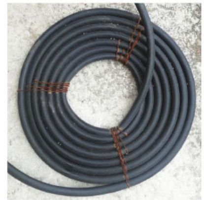
Figura 2.51 Estos calentadores solares de agua se fabricaron a partir de mangueras de plástico negro ya que absorben la energía térmica e impiden que se disipe.
