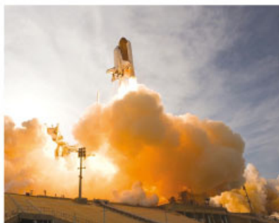
Figura 1.29 La presión ejercida por los gases, producto de la combustión, impulsa al cohete.
