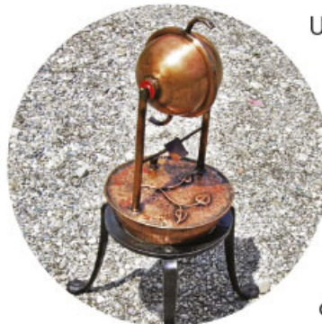
Figura 1.48 La eolípila consistía en una esfera llena de agua caliente. El vapor producido salía a presión por dos tubos y hacía girar la esfera.
