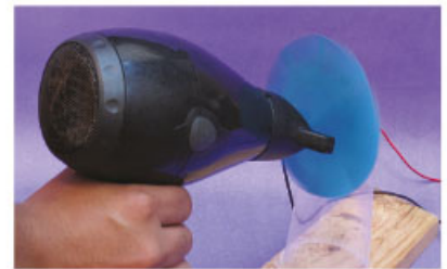
Figura 4.27 La secadora proporcionará el viento para mover las aspás.
