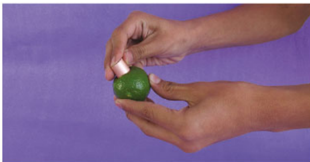
Figura 4.12 Al introducir la pieza de cobre y el tornillo en el limón, cuida de no hundirlos completamente.
