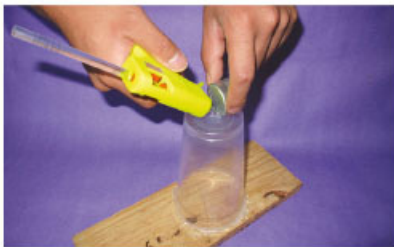
Figura 4.23 Asegúrate de que el motor quede pegado con firmeza.
