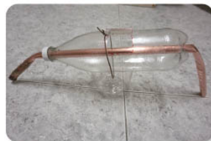
Figura 4.9 Ajusta la base que sostendrá la botella de manera que tenga una inclinación que permita la caída de la esencia.
