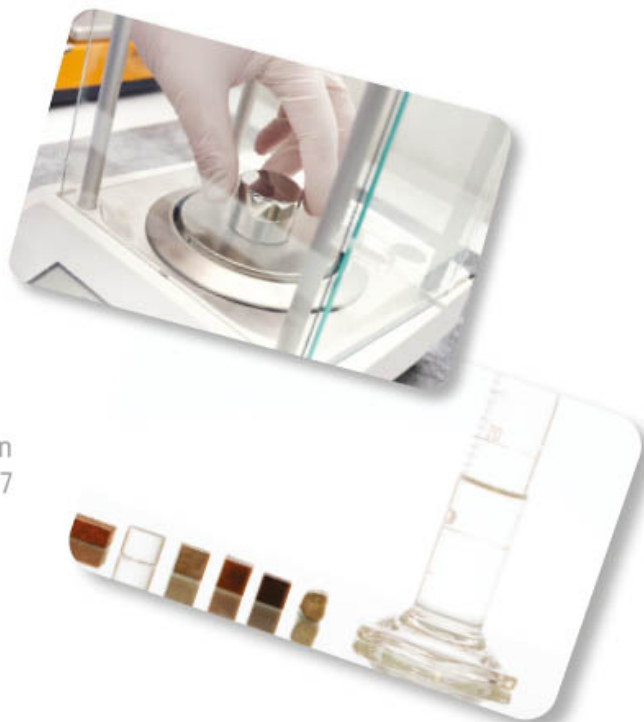
Figura 1.5 Con una báscula se puede cuantificar la masa de un material, mientras que en una probeta con agua se puede conocer el volumen de un objeto si se mide el volumen de líquido desplazado por éste.
