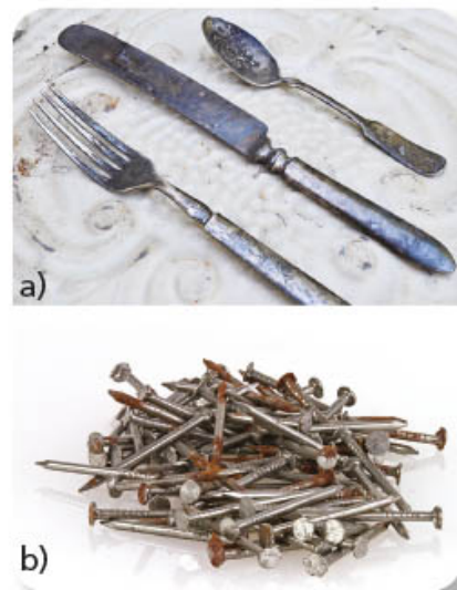
Figura 3.2 a) Los objetos de plata reaccionan con el azufre del aire cubriéndose con una capa negra de sulfuro de plata; b) los de hierro reaccionan con el oxígeno generando el óxido de hierro que le da su aspecto rojizo.
