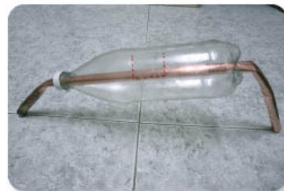
Figura 4.8 Las puntas del tubo de cobre deben ir hacia abajo. Realiza la ventana en la parte de arriba de la botella.
