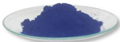
Figura 1.31 Los pigmentos son sustancias sólidas que absorben una parte de la luz y reflejan el resto. El color percibido es la luz reflejada.
