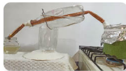
Figura 4.10 La olla debe estar completamente sellada para que el vapor se dirija al interior del tubo de cobre.
