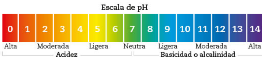
Figura 3.1 Los indicadores ácido-base son sustancias que cambian de color dependiendo del pH. Los colores en esta escala corresponden a los del llamado indicador universal .
