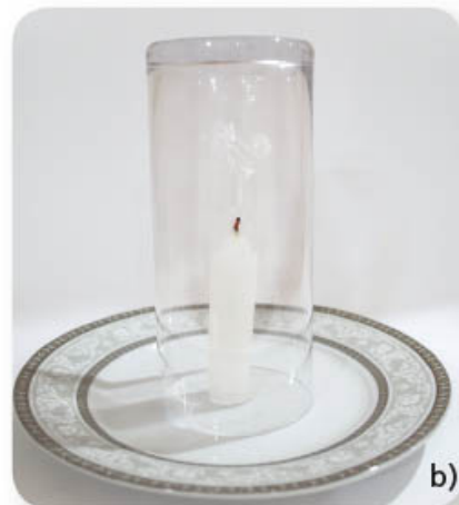
Figura 2.18 a) La combustión de la vela sucede a rapidez constante porque la concentración del oxígeno en el ambiente es alta y no se ve afectada por el proceso, pero b) al cubrirla con un vaso, las condiciones cambian.
